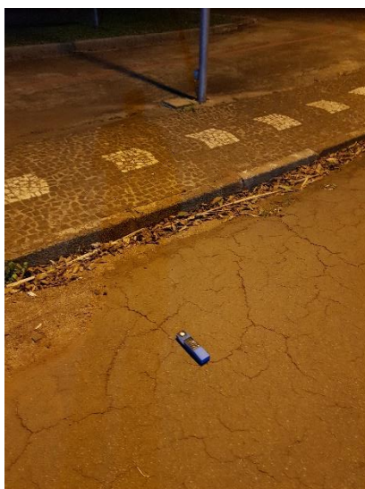
Figura 2. Medição do índice de iluminância.
