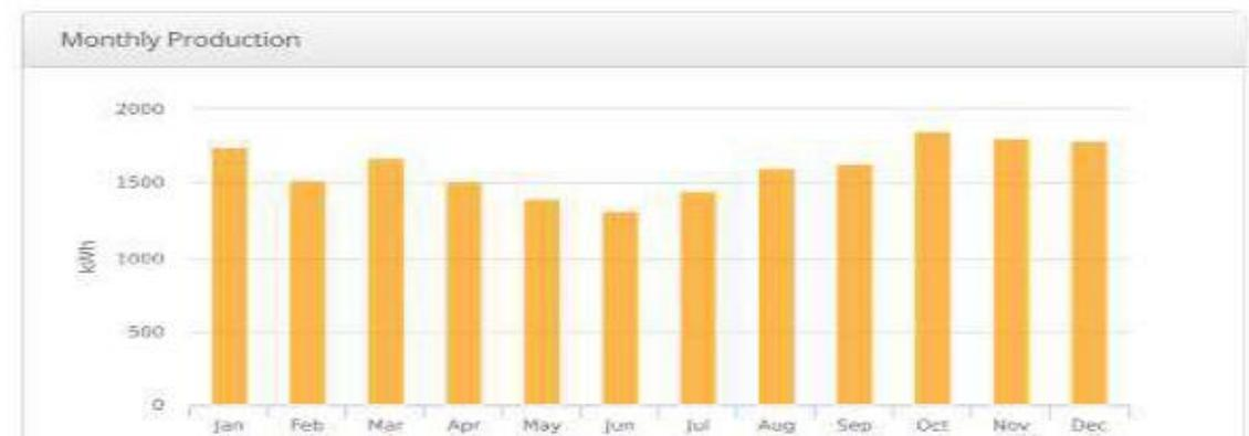
**Figura 1.** Geração para o sistema instalado em kWh.
