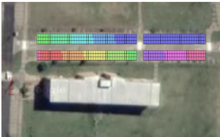
Figura 1 - Disposição módulos fotovoltaicos - estacionamento AT7
