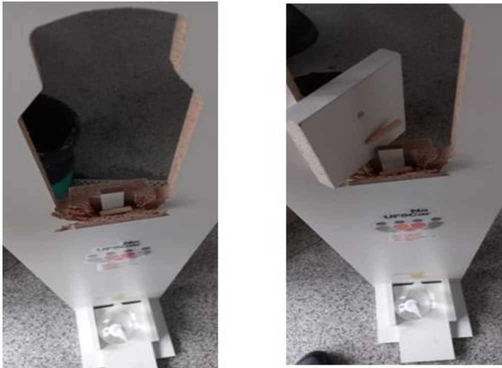
Figura 11 – Exemplos de Totens que foram danificados ao serem dispostos em áreas públicas de circulação.
