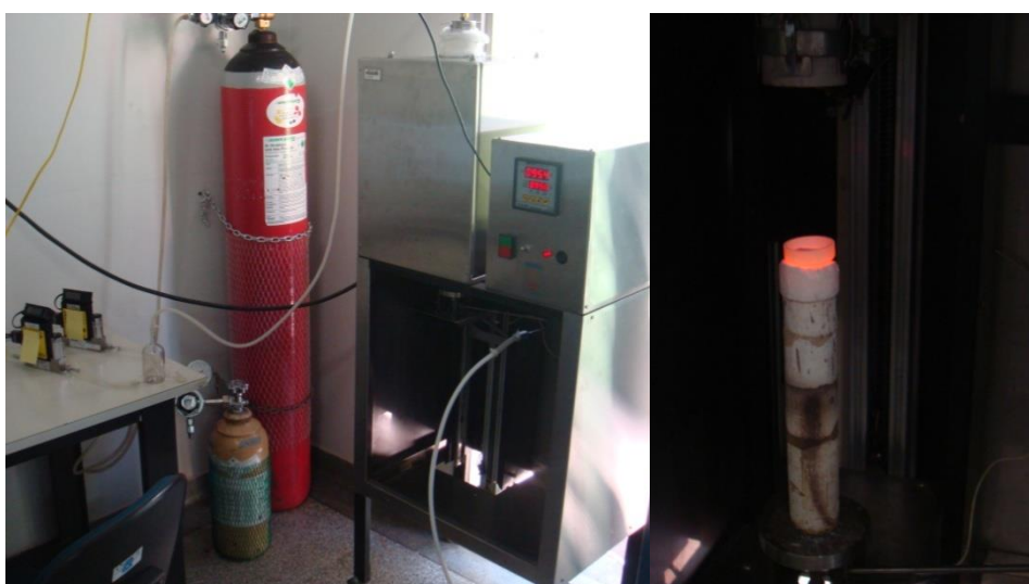
Figura 9: Forno Tubular Maitec, cilindros de gas e controladores de fluxo mássico Aalborg à esquerda e elevador com cadinho contendo amostra retirada do forno tubular imediatamente após a finalização do teste, à direita (Ávila, 2010)
